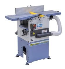
Die Abricht- und Dickenhobelmaschine PT 305 DS bietet durch das umfangreiche Standardzubehör (integrierte Absaugung, Spänesack, Fahrwerk, ...) ein optimales Preis-Leistungsverhältnis für den kostenbewussten Heimwerker. Die Spiralmesser-Hobelwelle für eine verminderte Lärmbelastung und optimale Hobelergebnisse ist ein weiteres Plus dieser Maschine.
