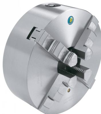
Das Bernardo Standard-4-Backenfutter DK12-200/D4 ist ein 4-Backenfutter aus Guss. Es ist geeignet für konventionelle Drehmaschinen und verfügt über eine Camlock-Direktaufnahme nach DIN 55029.
