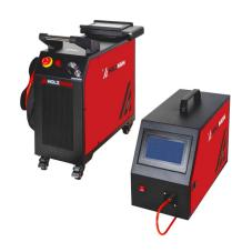
Die HOLZMANN LASER12\_230V Schweißanlage ist ein 1,2 kW luftgekühltes Multitalent. Es ermöglicht Schweißen, Entrosten und Schneiden alles in einem Gerät. Moderne Technik inklusive Drahtvorschubgerät, benutzerfreundliches Display und Ersatzdüsen/Linsenset.
