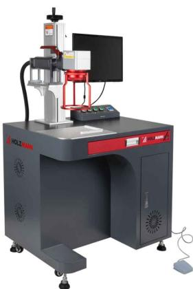
Die HOLZMANN Laserbeschriftungsmaschine LMM30W\_230V, beschriftet Metalle, Keramiken und beschichtete Metalle schnell und präzise.
