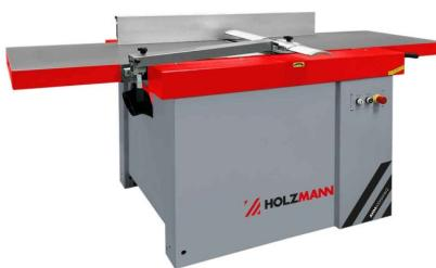
HOLZMANN Abrichthobelmaschine AHM410SMW2\_400V – Präzision auf ganzer Linie! Setzen Sie auf höchste Verarbeitungsqualität und maximale Effizienz: Die HOLZMANN Abrichthobelmaschine überzeugt mit seiner Spiralmesser-Hobelwellenausführung und einer großzügigen Abrichtbreite von 410 mm – ideal für anspruchsvolle Hobelarbeiten im professionellen Einsatz. Perfekt für Tischlereien, Zimmereien und ambitionierte Holzprofis, die Wert auf Leistung, Präzision und Langlebigkeit legen.
