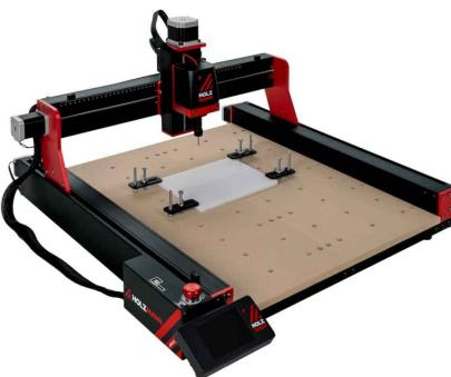
Die HOLZMANN CNC Tischfräsmaschine CTF45P ist vielseitig und einfach zu bedienen. Mit dem 460 x 460 mm großen Arbeitsbereich und dem optional erhältlichen Zubehör ist sie die perfekte Maschine, wenn Sie Holz, Kunststoff oder auch Aluminium bearbeiten möchten.
