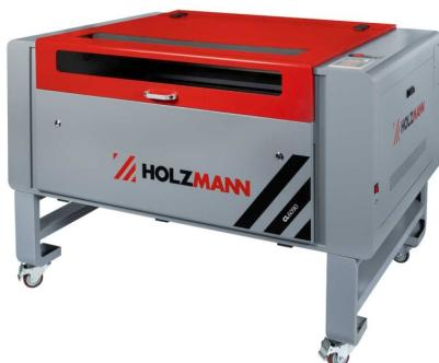
Der HOLZMANN CL6090 ist ein leistungsstarker CO<sub>2</sub>-Laser zum Gravieren und Schneiden nicht-metallischer Materialien wie Holz, Leder, Acryl, Glas und Kunststoff. Mit einer Arbeitsfläche von 600 x 900 mm und einer Laserleistung von bis zu 80 Watt bietet die Maschine hohe Präzision, saubere Schnittergebnisse und gestochene scharfe Gravuren.
