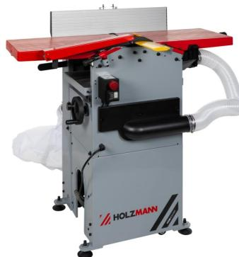
Die HOLZMANN HOB305ABS\_400V ist eine Abricht-Dickenhobelmaschine mit integrierter Absauganlage. Sie sparen Platz und Kosten für eine externe Absauganlage. Durch die serienmäßig enthaltene Fahreinrichtung ist sie nach Gebrauch im Nu weggeschafft – ein zusätzliches Plus bei begrenzten Platzverhältnissen!
