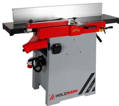
Die HOLZMANN HOB310ECOSMW2\_400V Abricht-Dickenhobelmaschine mit 310 mm Hobelmesserlänge, Abricht-Dickenhobelfunktion, Spiralmesserwelle und optionaler Langlochbohrvorrichtung sollte in keiner Holzwerkstatt fehlen. Sehr einfaches Umrüsten von Abricht- auf Dickenhobelbetrieb dank hochklappbarem Abrichttisch.
