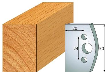
Das Profilmesser SET besteht aus einem Messer-Paar und einem Abweiser-Paar, jeweils 50x4 mm groß, und ist für Messerköpfe von IGM, CMT, Pilana, Flury, Guhdo, Holzmann, Bernardo usw. bestimmt. Es bietet genaue Bohrungen für ein genaues Platzieren im Messerkopf und wird mit einer Aufnahme von 40 mm oder 50 mm angeboten. Die Messer sind aus legiertem Werkzeugstahl hergestellt und präzise geschliffen.
