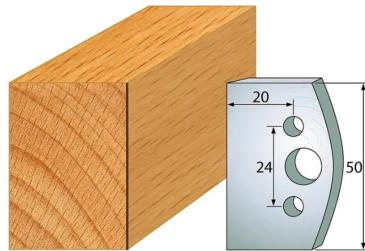
Das Profilmesser Abweiser-Paar 50x4 mm (2 Stk.) ist für Messerköpfe von IGM, CMT, Pilana, Flury, Guhdo, Holzmann, Bernardo usw. bestimmt. Es bietet genaue Bohrungen für genaues Platzieren im Messerkopf und wird mit Aufnahme von 40 mm oder 50 mm angeboten. Das Profilmesser ist aus legiertem Werkzeugstahl hergestellt und präzise geschliffen.
