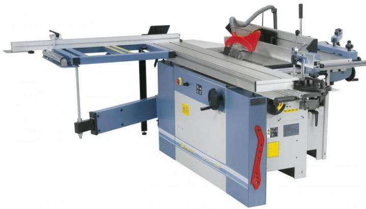
Das Holzbearbeitungszentrum CU 310 F bietet dem professionellen Anwender ein Höchstmaß an Einsatzmöglichkeiten und Leistung. Durch die Kombination aus Abricht-, Dickenhobel-, Kreissäge-, Fräse- und Langlochbohrmaschine bietet diese Maschine einen großen Einsatzbereich auf engstem Raum.
