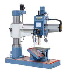
Die Radialbohrmaschine RD 2500 NC Vario ist für Bohr-, Senk- und Reibarbeiten von großen Werkstücken ideal geeignet. Die Besonderheiten dieses Modells sind die Bedienung über einen großdimensionierten Touchscreen sowie der Pinolenvorschub mittels Servomotor. Durch die vielseitigen Anwendungsmöglichkeiten ist diese Maschine optimal für mechanische Werkstätten, Reparaturbetriebe, Maschinenbau.
