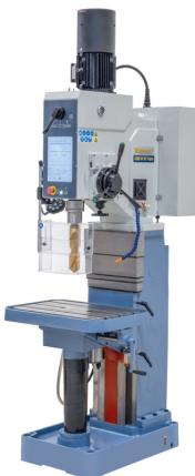
Die Kastenständerbohrmaschine KBM 65 NC Vario ist serienmäßig mit einer stufenlosen Drehzahlregelung ausgestattet, wodurch die Schnittgeschwindigkeit optimal an das Werkstück angepasst werden kann. Die Besonderheiten dieses Modells sind die Bedienung über einen großdimensionierten Touchscreen sowie der Pinolenvorschub mittels Servomotor.
