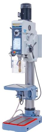
Die Getriebe-Säulenbohrmaschine GB 75 NC überzeugt durch ihre große Bohrleistung von 70 mm, die massive Bauweise sowie durch die umfangreiche Grundausstattung. Dadurch ist dieses Modell für den Einsatz in der industriellen Fertigung und der Serienproduktion ideal geeignet.
