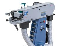
Die KBR 100 x 2000 DC-2 ist eine multifunktionelle Schleifmaschine zum Rohr- und Profilendenschleifen an der Vorderseite, zum Schleifen von Kanten, Flächen und zum Rundschleifen an der Rückseite sowie zum Planschleifen auf der Maschinenoberseite. Zusätzlich ist dieses Modell serienmäßig mit einer integrierten Absaugung ausgestattet.
