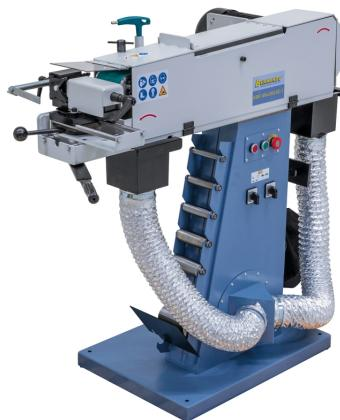
Die KBR 100 x 2000 DC-2 ist eine multifunktionelle Schleifmaschine zum Rohr- und Profilendenschleifen an der Vorderseite, zum Schleifen von Kanten, Flächen und zum Rundschleifen an der Rückseite sowie zum Planschleifen auf der Maschinenoberseite. Zusätzlich ist dieses Modell serienmäßig mit einer integrierten Absaugung ausgestattet.
