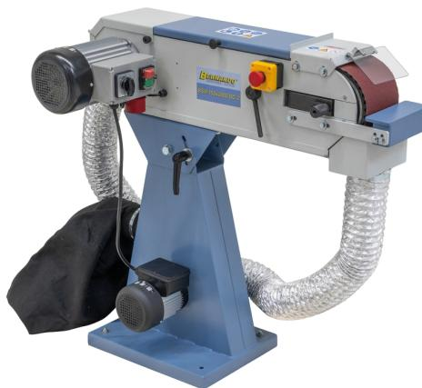
Die Bernardo Bandschleifmaschine mit Absaugung BSM 150 x 2000 DC-2 / 400 V ist eine universell einsetzbare Maschine zum Schleifen von Kanten, Flächen und zum Rundschleifen. Sie ist serienmäßig mit integrierter Absaugung für optimale Produktionsbedingungen und saubere Luft am Arbeitsplatz ausgestattet. Die Maschine verfügt über 2 Geschwindigkeiten, was sie optimal zum Schleifen von Edelstahl macht.
