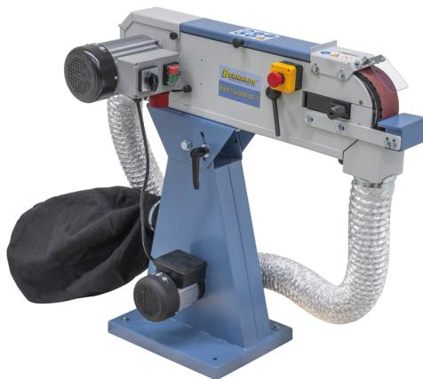
Die Bernardo Bandschleifmaschine mit Absaugung BSM 75 x 2000 DC-2 / 400 V ist eine universell einsetzbare Maschine zum Schleifen von Kanten, Flächen und zum Rundschleifen. Sie ist serienmäßig mit integrierter Absaugung für optimale Produktionsbedingungen und saubere Luft am Arbeitsplatz ausgestattet. Die Maschine verfügt über 2 Geschwindigkeiten, optimal zum Schleifen von Edelstahl.
