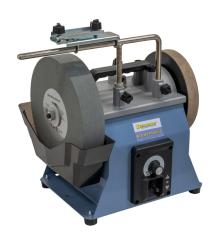
Die Bernardo NTS 250 Pro Vario Nass- und Trockenschleifmaschine ist ein formschönes Profimodell aus stabilem Stahlblech mit drehmomentstarkem Antriebsmotor für optimale Schleifergebnisse. Sie ist serienmäßig mit stufenloser Drehzahlregelung ausgestattet, ideal zum Anpassen an das jeweilige Material. Die Edelkorund-Schleifscheibe läuft im Wasserbehälter, dadurch wird die Schneide beim Schleifen gekühlt und so ein Ausglühen bzw. Überhitzen des Werkzeuges verhindert.
