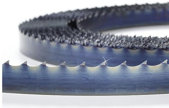
Das Bandsägeblatt A-BSB810SMARTB32 für BBS810SMART Blochbandsäge ist 4015 mm lang, 32 mm breit und 1 mm stark. Es ist geeignet für Nadelholz, europäisches Laubholz und zum Teil tropisches Hartholz. Das Blatt ist verlässlich auch bei härteren Holzarten und weist eine Flexback-Form auf. Es ist gezahnt, geschränkt, geschärft und geschweißt. Dieses Blatt ist nachschärfbar.
