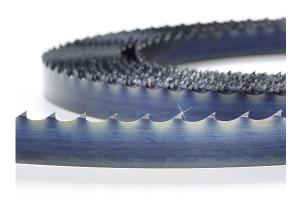
Das Bandsägeblatt A-BSB810SMARTB32 für BBS810SMART Blochbandsäge ist 4015 mm lang, 32 mm breit und 1 mm stark. Es ist geeignet für Nadelholz, europäisches Laubholz und zum Teil tropisches Hartholz. Das Blatt ist verlässlich auch bei härteren Holzarten und weist eine Flexback-Form auf. Es ist gezahnt, geschränkt, geschärft und geschweißt. Dieses Blatt ist nachschärfbar.
