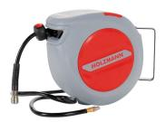
Der HOLZMANN Luftschlauchaufroller LSR15AIR ist mit einer schwenkbaren Wandhalterung ausgestattet und besitzt einen automatischen Aufrollmechanismus mit Führungsmechanik, der durch leichtes Gegenziehen aktiviert wird. Das stäbile Kunststoffgehäuse und der 15 m + 1,5 m PVC-Luftschlauch ermöglichen die Druckluftversorgung zwischen Gerät und Druckluftanschluss.
