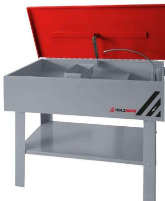
Das HOLZMANN Teilewaschgerät TW150\_230V perfekt zum Reinigen ihrer Werkstücke / Motorteile mit Reinigungsmitteln auf Wasserbasis.
