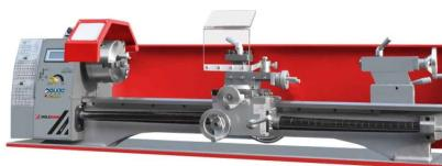
Die HOLZMANN ED420FXL\_230V ist eine kompakte Tischdrehmaschine für die Bearbeitung von Stahl, Guss, NE-Metallen, Alu, Messing und Kunststoffen. Mit einer Spitzentfernung von 735 mm können mit ihr auch überlange Werkstücke bearbeitet werden. Die Prismenbettführung ist induktiv gehärtet und präzisionsgeschliffen. Hohe Rundlaufgenauigkeit und hochwertige Bauweise ergeben eine kompakte und durchzugsstarke Drehbank für den ambitionierten Metallbearbeiter.
