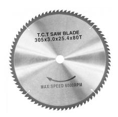
Das Bernardo HM-Kreissägeblatt WZ ist ein hochwertiges Sägeblatt für Kreissägen. Es hat einen Durchmesser von 305 mm, eine Breite von 3,0 mm und eine Bohrung von 25,4 mm. Das Sägeblatt verfügt über 80 Zähne und hat eine Wechselzahnform.
