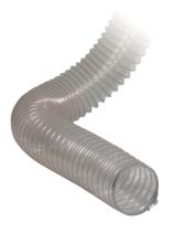
Der Absaugschlauch Ø 160mm 10lfm ist ein Polyurethan Flexschlauch. Die Nennweite beträgt 160 mm und die Materialstärke 0,4 mm. Der Biegeradius liegt bei 114 mm und der Arbeitsdruck max. bei 0,09 bar. Der Vakuum max. beträgt 0,06 bar. Die Werte wurden bei +23 °C gemessen.
