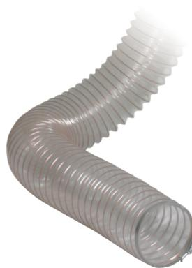
Der Absaugschlauch Ø 160mm 10lfm ist ein Polyurethan Flexschlauch. Die Nennweite beträgt 160 mm und die Materialstärke 0,4 mm. Der Biegeradius liegt bei 114 mm und der Arbeitsdruck max. bei 0,09 bar. Der Vakuum max. beträgt 0,06 bar. Die Werte wurden bei +23 °C gemessen.
