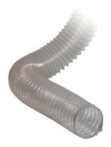
Der Absaugschlauch Ø 160mm 2,5lfm ist ein Polyurethan Flexschlauch. Die Nennweite beträgt 160 mm und die Materialstärke 0,4 mm. Der Biegeradius liegt bei 114 mm. Der maximale Arbeitsdruck beträgt 0,09 bar und das maximale Vakuum 0,06 bar. Die Werte wurden bei +23 °C gemessen.
