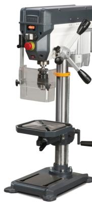
Die Optimum OPTIdrill DQ 20V Tischbohrmaschine ist eine preiswerte Tischbohrmaschine mit Keilriemenantrieb und mechanisch stufenlos einstellbarer Drehzahl. Sie verfügt über einen bedienungsfreundlichen Sicherheitsschalter nach IP 54, einen separaten Not-Halt-Schlagschalter und Sicherheitselektrik in 24 V Gleichspannung.
