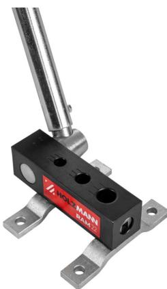
Die Holzmann RAM22 Rohrausklinkmaschine ist eine professionelle Lösung für das Ausklinken von Rohren. Mit einem 910mm langen Abzugshebel und Exzenterübersetzung ist sie speziell geeignet für Gas-, Edelstahl-, NE- und Dampfrohre. Die Maschine bietet drei unterschiedliche Durchmesser: 15, 18 und 22 mm, und kann sowohl horizontal als auch vertikal eingesetzt werden.
