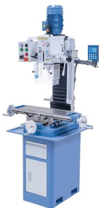
Das Modell BF 30 G ist eine kostengünstige Bohr- und Fräsmaschine. Durch die Schwalbenschwanzführung des Getriebekopfes wird ein Höchstmaß an Präzision und Stabilität gewährleistet. Ihren Einsatzbereich findet dieses Modell hauptsächlich beim Heimwerker.
