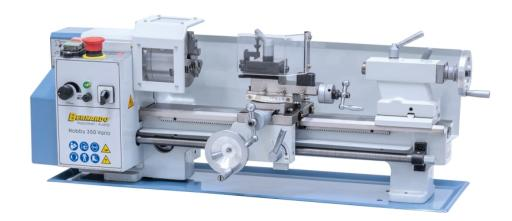
Die Tischdrehmaschine Hobby 350 Vario bietet zusätzlich - im Gegensatz zur Hobby 300 Vario - eine um 50 mm größere Spitzenweite sowie einen stärkeren Antriebsmotor. Zur Reduzierung der Fertigungszeiten kann dieses Modell mit einer 2-Achs-Digitalanzeige geliefert werden.
