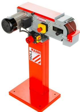
Die Holzmann MSM100NEO\_230V Metallschleifmaschine bietet ein optimales Schleifergebnis durch hohe Bandgeschwindigkeit und ermöglicht einen einfachen und schnellen Bandwechsel. Der kraftvolle Antrieb sorgt für einen kräftigen Durchzug und die Lauffläche mit Grafitbelag minimiert die Reibung. Die Feineinstellung ermöglicht einen perfekten Bandlauf.
