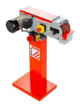
Die Holzmann MSM100NEO\_230V Metallschleifmaschine bietet ein optimales Schleifergebnis durch hohe Bandgeschwindigkeit und ermöglicht einen einfachen und schnellen Bandwechsel. Der kraftvolle Antrieb sorgt für einen kräftigen Durchzug und die Lauffläche mit Grafitbelag minimiert die Reibung. Die Feineinstellung ermöglicht einen perfekten Bandlauf.
