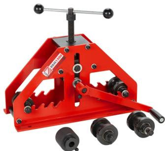
Die Holzmann RBM1500 Rohrbiegemaschine ist ein Gerät zum Biegen von Rund- (max. Ø38mm) sowie Vierkantrohren (max. 40mm) mit einer Rohrwandstärke bis zu 2mm (Baustahl). Ausgerüstet mit langer Handkurbel zur optimalen Kraftübertragung, bietet es vier unterschiedliche Arbeitspositionen für angepasste Biegeradien. Die robuste Stahlkonstruktion und die Bohrungen für die Fixierung auf einer Werkbank zeichnen es aus.
