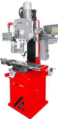
Die HOLZMANN Fräsmaschine ZX7045PRO mit umfangreicher Ausstattung wie Untergestell, 3-Achsen DRO, Kühlmittelpumpe-Tank, elektrischer Höhenverstellung Fräskopf, Vorschubapparat für X-Achse, Bedienpult ist ideal für ihre Metallbearbeitungswerkstatt und erledigt ihre Bohr und Fräsarbeiten präzise und einfach.
