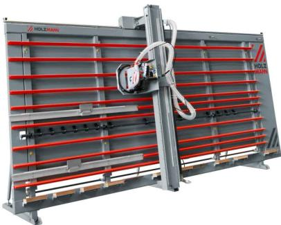
Die HOLZMANN Vertikalplattensäge VPS3216ECO\_230V ermöglicht es Platten mit 3,2m horizontal und 1,6m vertikal zu bearbeiten. Manuell verschiebbarer Lattenrost für eine sichere Bearbeitung in horizontaler Schnittrichtung. Zwei mechanische Anschläge für untere und mittlere Plattenauflage. Die mittlere Plattenauflage ist schwenkbar. Das Sägeaggregat ist die HOLZMANN Tauchsäge TAS165Pro.
