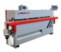
Die Holzmann KAM35SMART\_400V Kantenanleimmaschine ist eine einseitige, automatische Kantenanleimmaschine mit Touchscreen-Display. Sie verfügt über ein Fügeaggregat mit Doppelfräser, Anleimbecken mit Heizungsregelung, Kappsägeaggregat, Doppelfräsaggregat, Ziehklinge und Polieraggregat. Die Maschine bietet eine automatische und konstante Plattenvorschub dank Kettenförderantrieb und leistungsstarken Motor. Die Klebetemperatur kann elektronisch am Touch-Display eingestellt werden.
