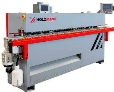
Die Holzmann KAM35SMART\_400V Kantenanleimmaschine ist eine einseitige, automatische Kantenanleimmaschine mit Touchscreen-Display. Sie verfügt über ein Fügeaggregat mit Doppelfräser, Anleimbecken mit Heizungsregelung, Kappsägeaggregat, Doppelfrässaggregat, Ziehklinge und Polieraggregat. Die Maschine bietet eine automatische und konstante Plattenvorschub dank Kettenförderantrieb und leistungsstarken Motor. Die Klebeterminatur kann elektronisch am Touch-Display eingestellt werden.
