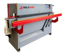
Die Holzmann KAM35EP\_400V Kantenanleimmaschine ist eine einseitige, automatische Kantenanleimmaschine mit Touchscreen-Display. Sie verfügt über ein Anleimbecken mit Heizungsregelung und Direktleimabgabe an gerade Werkstücke, ein Kappsägeaggregat zum Ablängen der Kante, ein Doppelfräsaggregat zum Abfräsen des Kantenüberstandes und ein Polieraggregat. Die Maschine hat eine Vorschubgeschwindigkeit von 8 m/min und eine Motorleistung von 3960 W.
