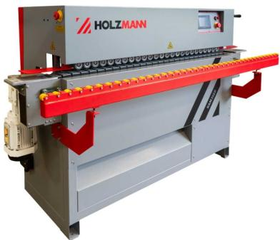
Die Holzmann KAM35EP\_400V Kantenanleimmaschine ist eine einseitige, automatische Kantenanleimmaschine mit Touchscreen-Display. Sie verfügt über ein Anleimbecken mit Heizungsregelung und Direkteleimabgabe an gerade Werkstücke, ein Kappsägeaggregat zum Ablängen der Kante, ein Doppelfräsaggregat zum Abfräsen des Kantenüberstandes und ein Polieraggregat. Die Maschine hat eine Vorschubgeschwindigkeit von 8 m/min und eine Motorleistung von 3960 W.
