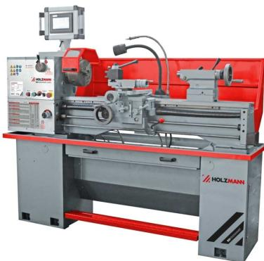
Die HOLZMANN Drehbank ED1000SMART\_400V mit Bedienpanel, automatischer Vorschubeinstellung für X und Z-Achse sowie Kühlmittelversorgung. Werkstücke mit einem Durchmesser von max 356 mm (500 mm) können damit bearbeitet werden (über Maschinenbett/ohne Brücke).
