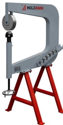
Die Holzmann RSM690-15 Rollenstreckmaschine ist eine kompakte Geräte für die Blechbearbeitung. Sie verfügt über einen Stahlrahmen und ist inklusive 6 wechselbare Rollen. Die Wechselrollen haben Durchmesser von Ø13 / 3" (76,2) / 4"(101) / 6"(152,4) / 8"(203,2) / 12" (304,8) mm. Das obere Rad hat eine Größe von Ø 200 x 51 mm.
