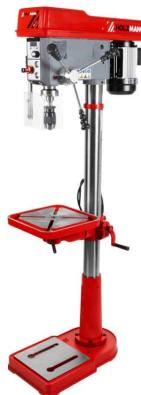
Die HOLZMANN Ständerbohrmaschine SB253VH\_230V ist eine verlässliche und wartungsarme Ständerbohrmaschine. Mittels Frequenzumrichter kann man die Drehzahl ganz einfach an die optimale Bearbeitungsdrehzahl Bohrer/Werkstück anpassen. Sie hat einen verbauten Bohrzentrierlaser und ein LED-Arbeitslicht, um genaues Arbeiten zu gewährleisten.
