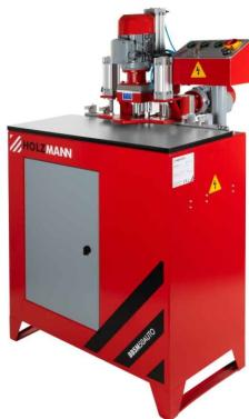
Mit der HOLZMANN automatische Bohr-und Beschlagsetzmaschine BBSM50AUTO schaffen sie die Bohrungen um 2 Paneele zu verbinden. 4 Dübel sowie 2 Exzenterspanner + schrauben und passender Gewindeeinsatz einsetzen und schon schaffen sie die Verbindung für ihre Möbelstücke.
