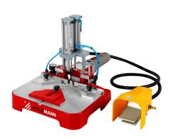
Die HOLZMANN pneumatische Doppel-Keilnutfräsmaschine KNF2PNEU\_230V mit zwei Frässpindel ideal zur Herstellung von zwei Keilnutverbindungen pro Arbeitshub. Bilderrahmen, Fensterrahmen und viele weitere Rahmenverbindungen lassen sich schnell und bequem herstellen. Fräsen, passende Schwalbenverbindungelement einlegen und schon sind die beiden bearbeiteten Teile miteinander verbunden (kein Kleber notwendig)
