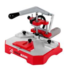
Die HOLZMANN Keilnutfräsmaschine KNF1\_230V mit einer Frässpindel ideal zur Herstellung von einer Keilnutverbindungen pro Arbeitshub. Bilderrahmen, Fensterrahmen und viele weitere Rahmenverbindungen lassen sich schnell und bequem herstellen. Fräsen, passende Schwalbenverbindungelement einlegen und schon sind die beiden bearbeiteten Teile miteinander verbunden (kein Kleber notwendig).
