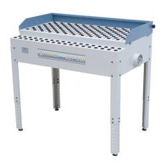
Der Schleifstaub-Absaugtisch BDT 1250 eignet sich zum Auffangen von Staub, der beim manuellen bzw. maschinellem Schleifen von Teilen aller Art anfällt. Durch den beidseitigen Absauganschluss kann der Absaugtisch an eine bestehende Absauganlage angeschlossen werden und die staubhaltige Luft wird durch die Tischoberfläche abgesaugt.
