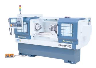
Die Bernardo CK 400 x 750 CNC-Drehmaschine ist eine leistungsstarke Maschine für die Metallverarbeitung. Mit einer Spitzenweite von 750 mm und einer Spitzenhöhe von 200 mm bietet sie eine Vielzahl von Möglichkeiten für die Bearbeitung von Werkstücken.
