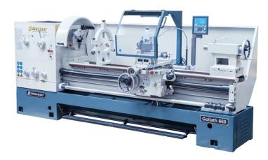
Die Produktionsdrehmaschine Goliath 660 ist eine moderne, dem heutigen Stand der Technik entsprechende Maschine. Schon die Grundausstattung beinhaltet alle wichtigen Zubehöre (3-Backenfutter, Lünetten, Wechselräder, 3-Achs-Digitalanzeige, Schnellwechselstahlhalter, ....) wodurch diese Maschine universell einsetzbar ist.
