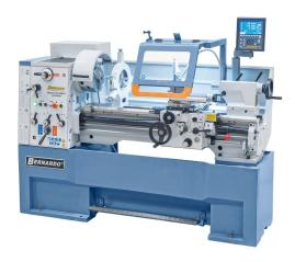
Die Universaldrehmaschine Smart 410 V-constant überzeugt durch ihre stabile Konstruktion und einfache Handhabung. Schon die Grundausstattung beinhaltet alle wichtigen Zubehöre, wodurch diese Maschine ideal für Fachschulen, Reparaturbetriebe und Ausbildungswerkstätten ist. Weiters ist dieses Modell mit der Zusatzfunktion "konstante Schnittgeschwindigkeit" ausgestattet, d.h. auch bei verändertem Werkstückdurchmesser wird eine optimale Oberflächengüte erzielt.
