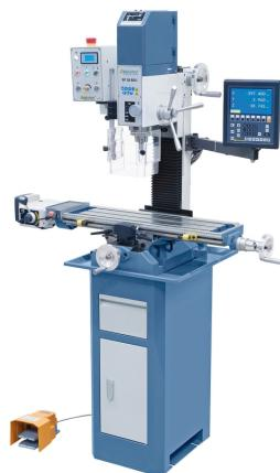
Die Bohr- und Fräsmaschine BF 28 BDC ist serienmäßig mit einem hochwertigem Gleichstrommotor ausgestattet. Wesentliche Vorteile, die sich daraus ergeben, sind das hohe Drehmoment im unteren Drehzahlbereich und die annähernd konstante Drehzahl unter Last. Ihren Einsatzbereich findet dieses Modell hauptsächlich beim professionellen Anwender, im Modellbau, aber auch im Ausbildungsbereich.
