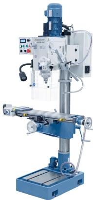
Mit der Bohr- und Fräsmaschine BF 45 HSV Vario hat man die Möglichkeit Bohr- und Fräsurarbeiten in horizontaler, vertikaler und schräger Ebene durchzuführen. Durch die kompakte Bauweise, dem serienmäßigen Pinolenvorschub, der digitalen Pinolenhubanzeige und der stufenlosen Drehzahlregelung ist dieses Modell für Modellbauer, Handwerker und Reparaturwerkstätten optimal geeignet.
