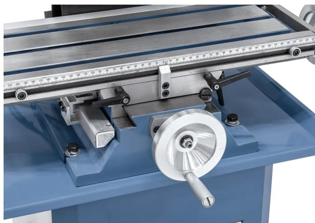
Die Bohr- und Fräsmaschine KF 18 Top ist serienmäßig mit einem hochwertigem Gleichstrommotor ausgestattet. Wesentliche Vorteile, die sich daraus ergeben, sind das hohe Drehmoment im unteren Drehzahlbereich und die annähernd konstante Drehzahl unter Last. Ihren Einsatzbereich findet dieses Modell hauptsächlich beim professionellen Anwender, im Modellbau, aber auch im Ausbildungsbereich.
