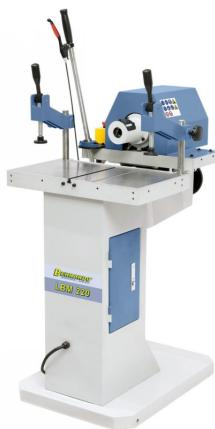
Die Langlochbohrmaschine LBM 220 bietet eine verwindungsfreie Stahlkonstruktion und einen festmontierten, großen Graugusstisch mit geschliffener Oberfläche. Durch die serienmäßigen Tischverbreiterungen und -verlängerung können auch große Werkstücke bearbeitet werden.
